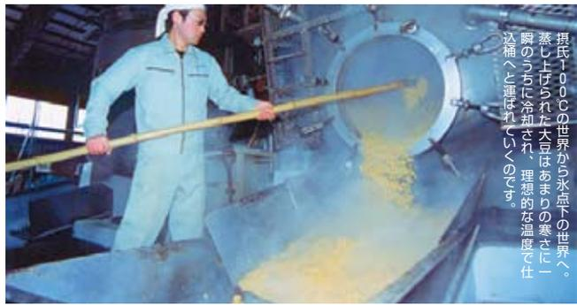
摂氏100℃の世界から氷点下の世界へ。蒸し上げられた大豆はあまりの寒さに一瞬のうちに冷却され、理想的な温度で仕込桶へと運ばれていくのだ。
