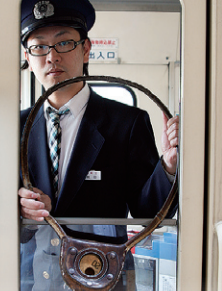
運転士が手にするのは、単線区間を走行する際に必須となるタブレット。いわゆる通行手形のようなもの。ちなみに、全線単線の由利高原鉄道の「閉塞方式」は、羽後本荘～前郷がスタッフ方式、前郷～矢島がタブレット方式。
