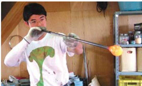
ドロドロに融けた硝子を吹きざおに巻き付け息を吹き込んで膨らませる
