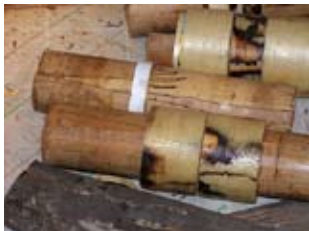
原料の桜の樹皮を削る樺削り（樺はたじ）。原材料となる樺は、オオヤマザクラ（カスミザクラ）、表面のツブホコをこそげ落とす樺細工職人にとっては基本となる大切な作業。普及品は機械で削ることが多いが、仕上がりの良さは手作業にはかなわない。
